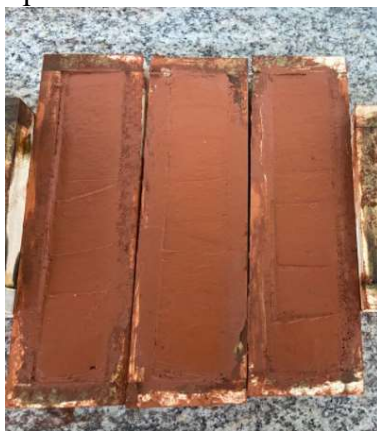
Figura 3.13: CP's prismáticos moldados em forma de madeira.
