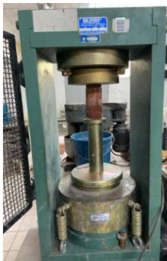
Figura 3.12: CP cilíndrico submetido ao ensaio de resistência à compressão.
