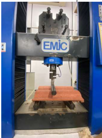
Figura 3.19: Ensaio de resistência à tração na flexão das telhas.
