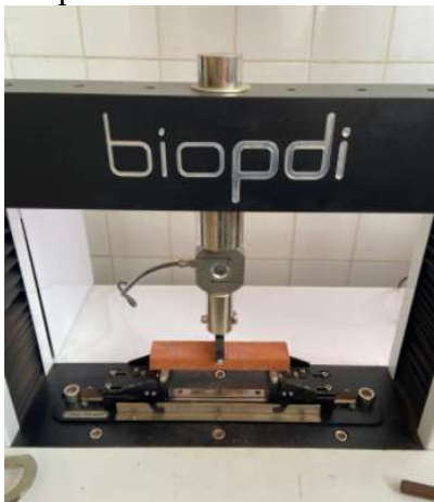
Figura 3.14: CP prismático na iminência de ser rompido.
