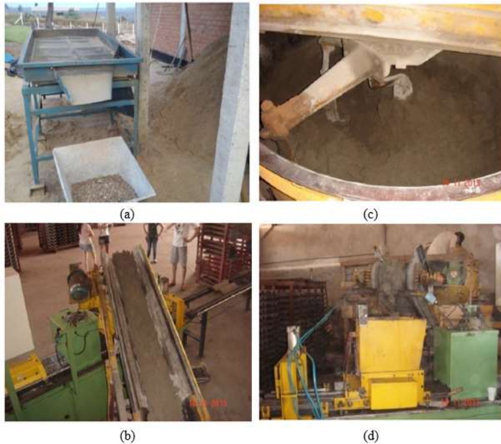
Figura 2.20: Processo de fabricação de telha de concreto. (a): peneiramento da areia. (b): esteira. (c): misturador. (d): extrusora.
