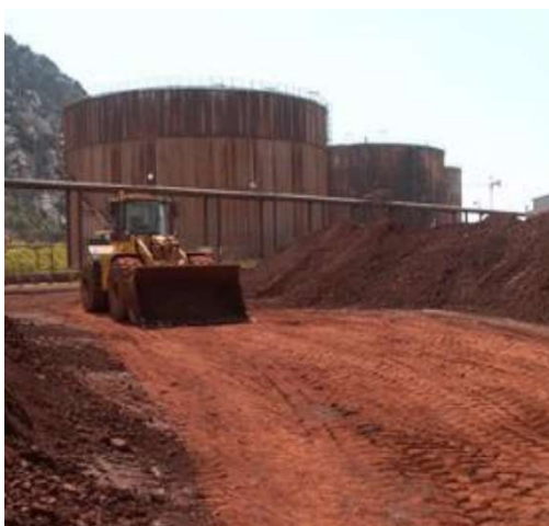
Figura 2.6: Exemplo de estocagem a seco de resíduo de bauxita (dry-stacking).
