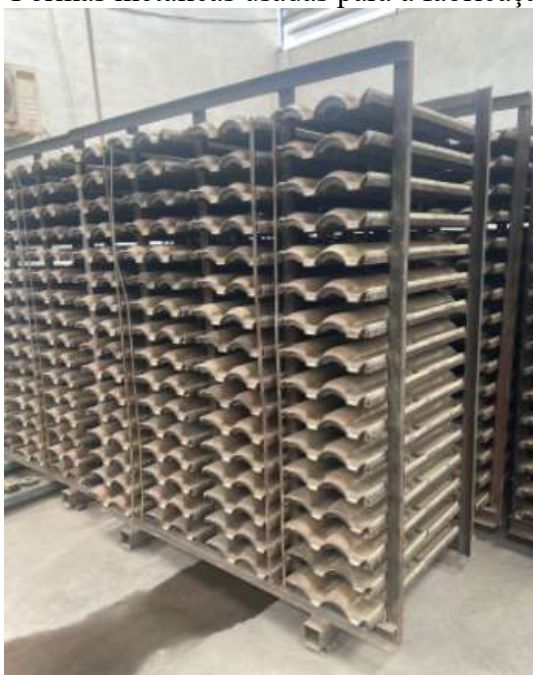
Figura 3.16: Formas metálicas usadas para a fabricação das telhas.
