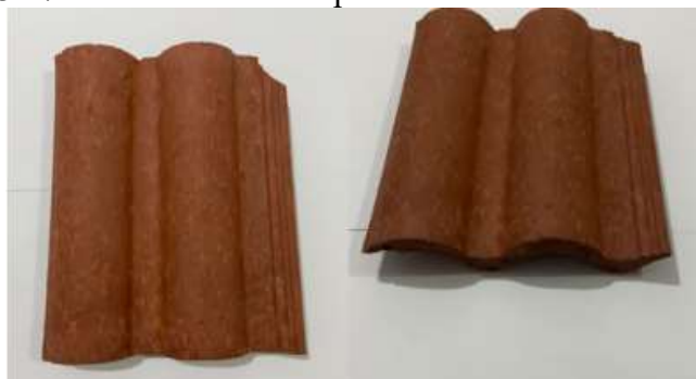
Figura 3.17: Telha de concreto produzida com resíduo da bauxita.
